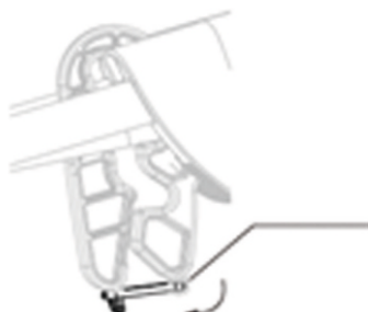
Рис. 5. Закрытое положение фиксатора
