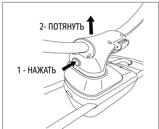
2. Что бы снять сиденье с опорной рамы, необходимо нажать на кнопку блокировки и потянуть кресло вверх.
