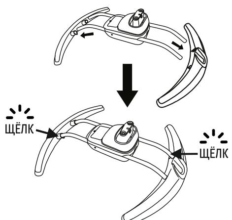
1. Вставьте круглую железную трубу основной рамы в цилиндрические отверстия переднего и заднего основания до щелчка.
