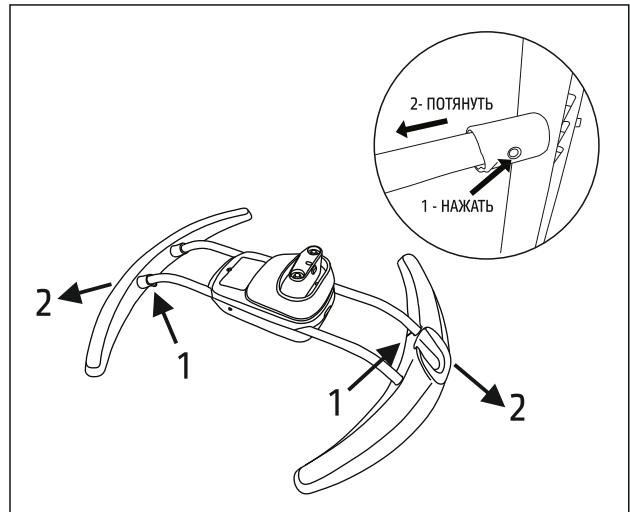
4. Что бы отсоединить круглую железную трубу основной рамы от переднего и заднего основания нажмите на кнопки и потяните трубы как показано на рисунке.
